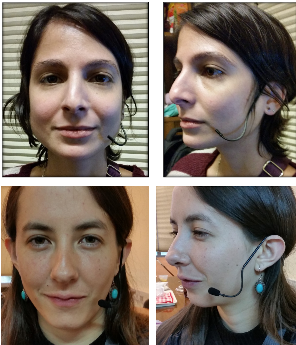
Figura 14. Imágenes del micrófono doblado y colocado correctamente.
