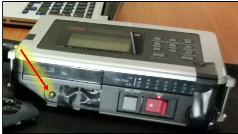
Figura 15. Grabadora de audio Fostex FR-2LE. La perilla que se gira para ajustar el volumen se señala con la flecha.
